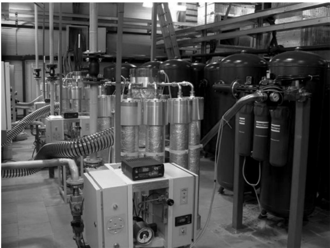
*Рисунок 2. Азотная мембранные установка*
