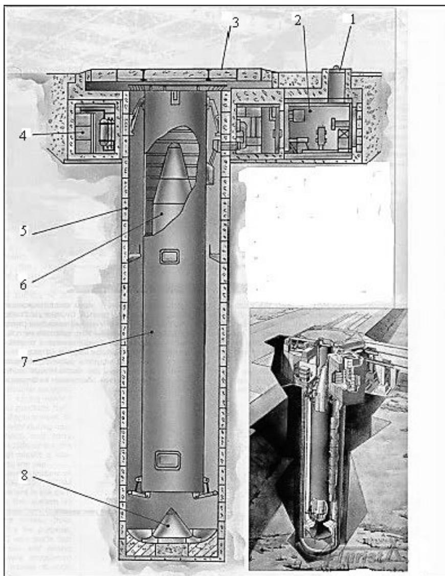
Рисунок 2. Устройство ШПУ.
