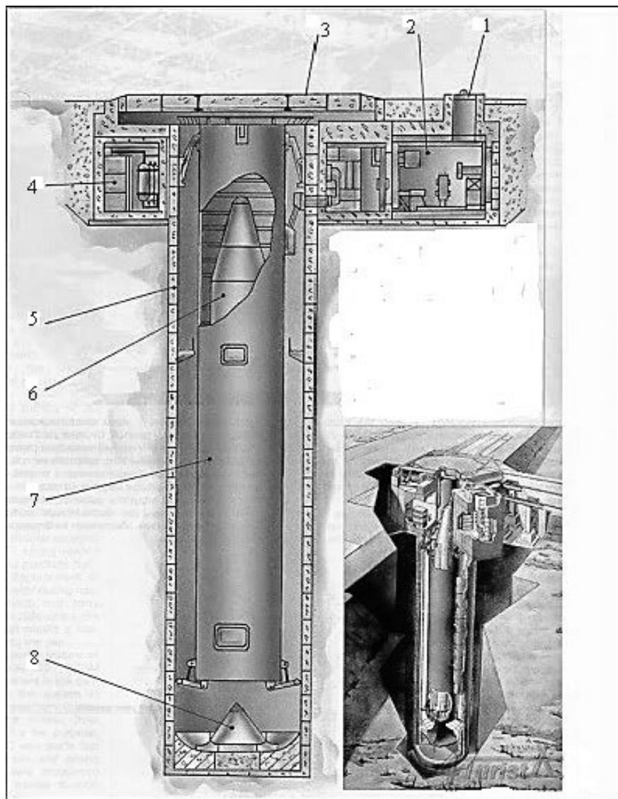
Рисунок 2. Устройство ШПУ.
